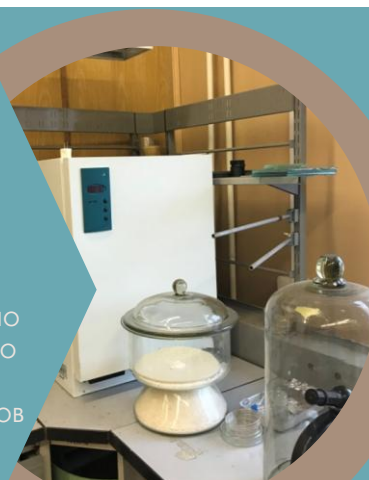
Камера для исследования антимикробных свойств упаковочных материалов
